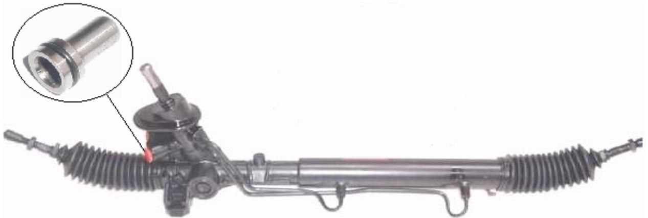
Unterschied zwischen SR2720 und SR2850 (= späteren Modellen) ist die Form der Lenkspindel. Das Rückschlagventil ist die gleiche und muss wieder verwendet werden, wenn es nicht bereits vormontiert ist.
